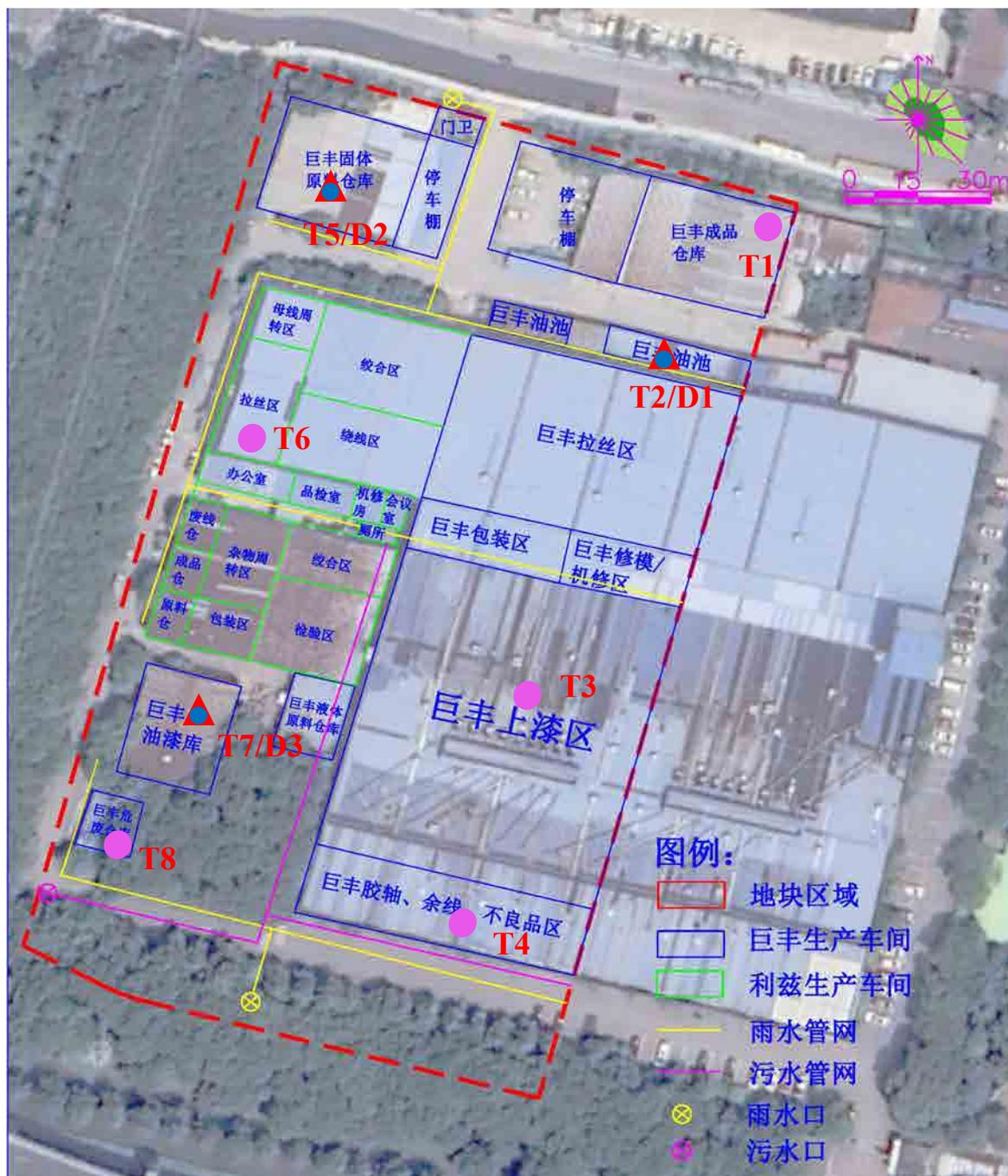
图 5-2 监测点位布设图（以生产车间为底图）
