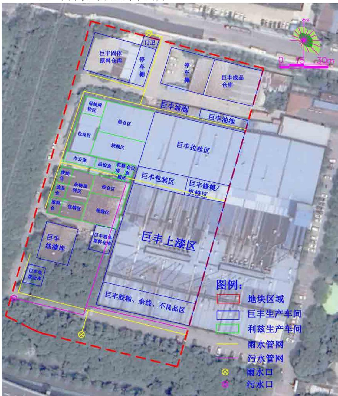
图 4-5 地块内平面布置及雨污水管网图
